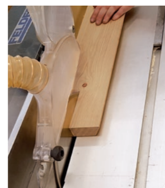
2. Réaliser une découpe précise pour chaque lame à claire-voie.
