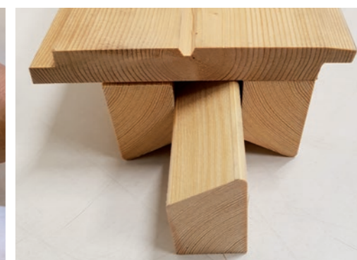
4. La largeur utile des lames à mi-bois correspond exactement à quatre fois l'épaisseur d'un profilé à claire-voie. Ainsi vous pouvez utiliser les profilés à claire-voie comme entretoise.
